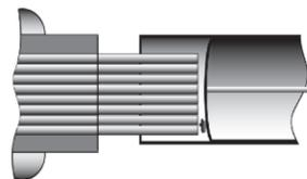
En el cabezal de cada CleanStixx™, la fibra flexible se adapta fácilmente a la cara de la fibra.
